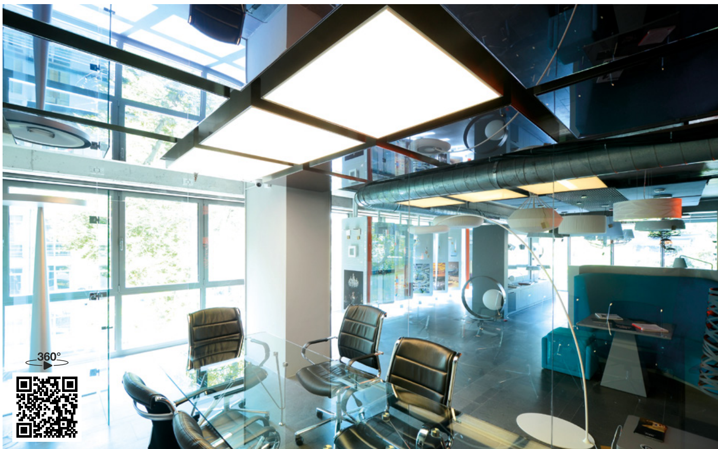
Arch. : Devrim Turan Combinaison de toile miroir et de toile translucide lumineuse / Combination of mirror membranes and translucent light membranes / Kombination aus Spiegel Spannfolie und lichtdurchlässigem Leucht Spannfolie
